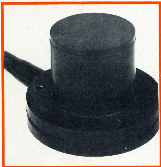
Fig. 21 - Idrofono omnidirezionale, a basso livello di rumore; interamente ricoperto in neoprene per assicurare una eccellente tenuta stagna all'acqua di mare.
