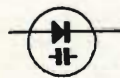
Fig. 6 - Simbolo di un diodo a giunzione a polarizzazione inversa usato come capacità.
