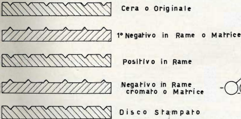
Fig. 4 - Sezioni relative al disco originale, al primo negativo, al primo positivo, al secondo negativo e al disco finito. Sulla destra sono indicate la polarità di carica nei processi galvanoplastici.
